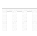
图 3 条粘法粘贴示意
